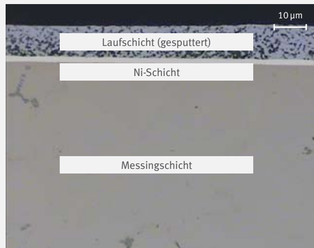
Schliffbild durch das Schichtsystem
