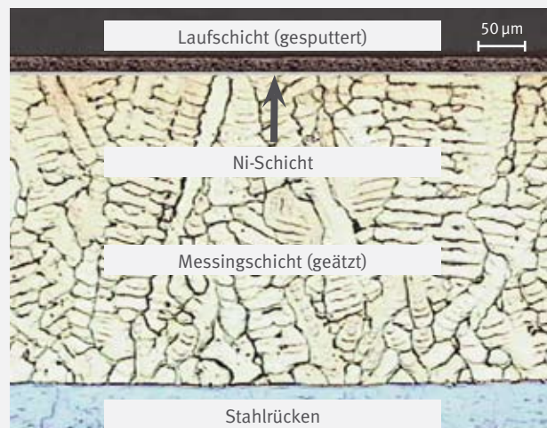
Schliffbild durch das Schichtsystem
