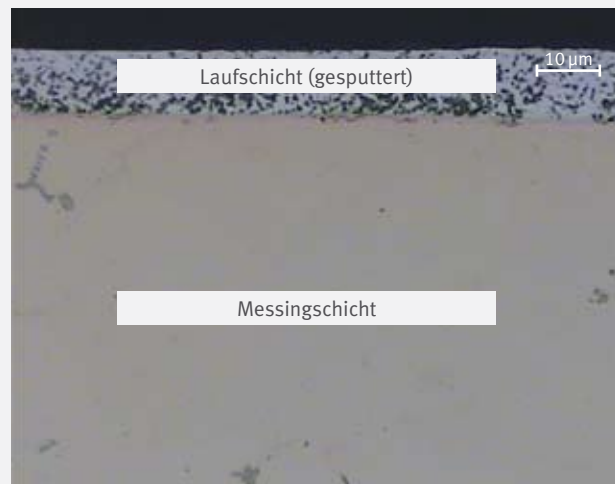
Schliffbild durch das Schichtsystem
