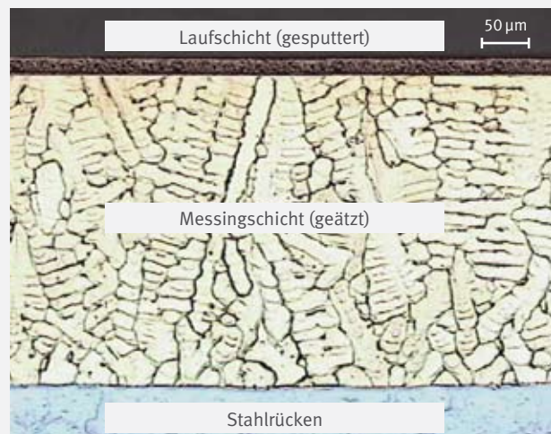
Schliffbild durch das Schichtsystem
