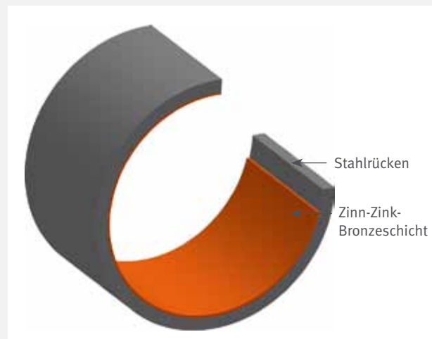
Schichtsystem: Stahl / Zinn-Zink-Bronze
