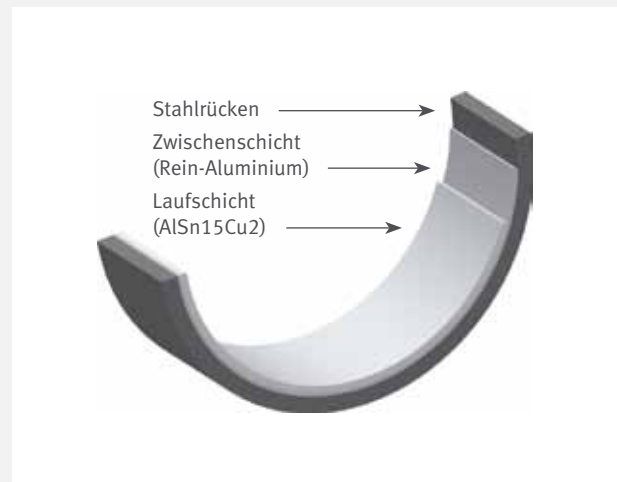
Schichtsystem: Stahl / Aluminium-2-Stofflager
