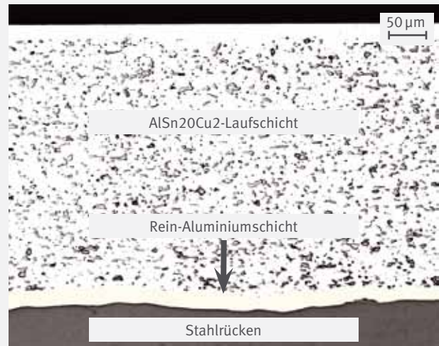
Schliffbild durch das Schichtsystem
