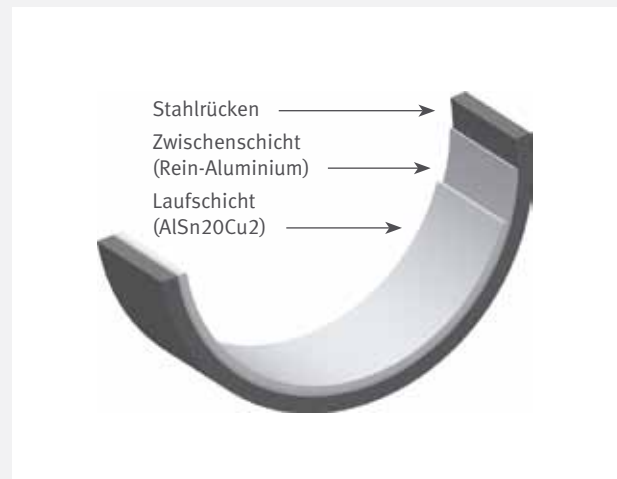
Schichtsystem: Stahl / Aluminium-2-Stofflager
