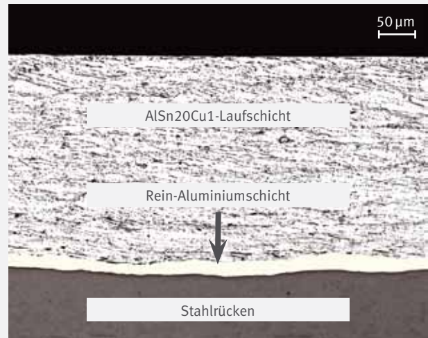
Schliffbild durch das Schichtsystem
