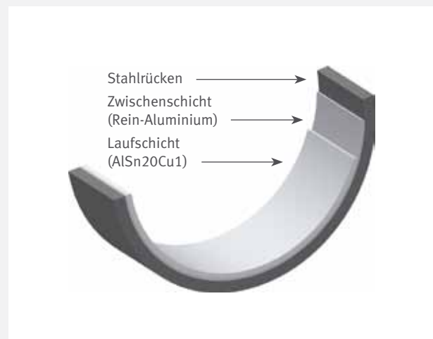
Schichtsystem: Stahl / Aluminium-2-Stofflager
