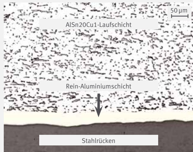
Schliffbild durch das Schichtsystem
